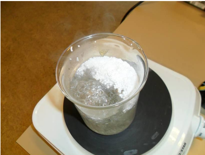
Abb. 4: Expandierbares Polystyrol nach dem Erhitzen (Durchmesser ca. 15 mm)
