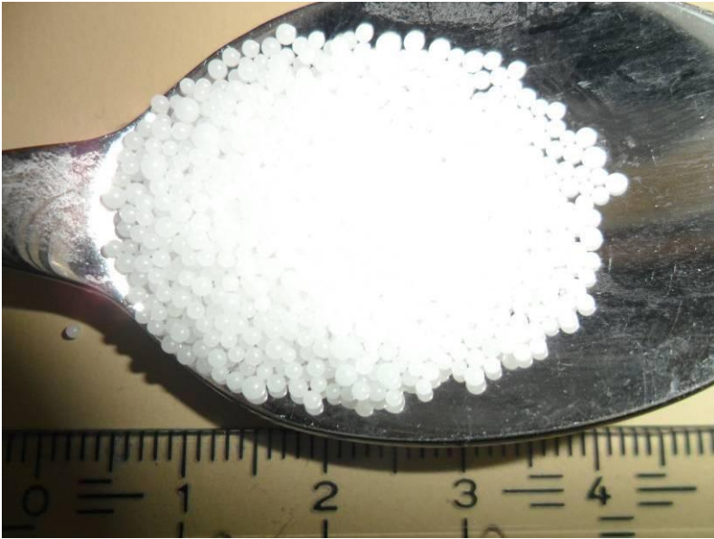
Abb. 3: Expandierbares Polystyrol vor dem Erhitzen (Durchmesser 0.3mm)
