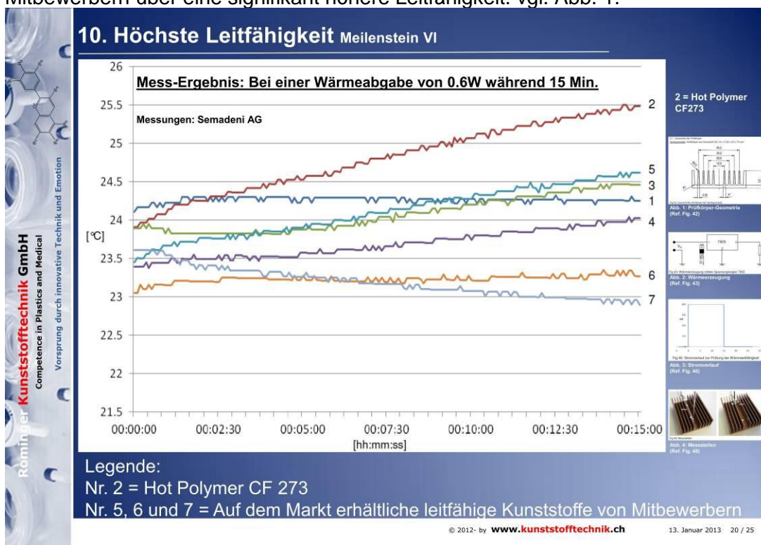
Abb. 1: Leitfähigkeits-Ergebnisse Hot Polymer CF 273 im Vergleich zu Werkstoffen von Mitbewerbern. (Auszug).
