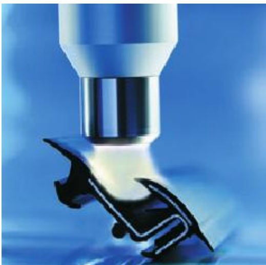
Abb. 5: Dargestellt ist eine Kunststoffoberfläche, die in Abhängigkeit von Abstand und Geschwindigkeit mit Plasma vorbehandelt wurde. Die Oberfläche wird nach der Behandlung polar und die Oberflächenenergie steigt auf > 72 mJ/m 2 bei grossem Prozessfenster. Quelle: Fachzeitschrift Kunststoffe.
