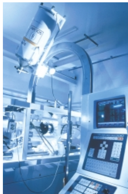
Abb. 3: Spezielles Andocksystem: Erst kurz vor der Materialaufschmelzung wird das Kunststoffgranulat freigegeben.
