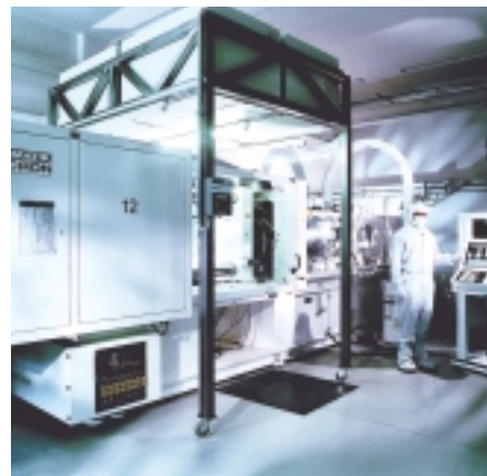
Abb. 1: Produktion unter reinsten Bedingungen: Gefertigt wird bei GEMÜ in Reinräumen der Klasse 8 (100.000). Mit Flow-Box-Systemen lassen sich die Spritzgießmaschinen an noch reinere Bedingungen anpassen.
