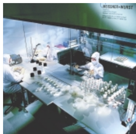
Abb. 2: Für Montage-, Test- und weitere Verpackungstätigkeiten verfügt GEMÜ über einen Reinraum der Klasse 5 (100)
