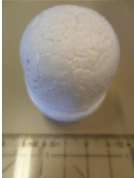
Abb. 6: Expandiertes Polystyrol aus Tee-Ei
