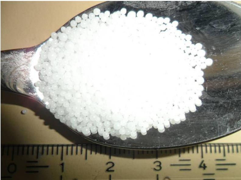
Abb. 3: Expandierbares Polystyrol vor dem Erhitzen (Durchmesser 0.3mm)
