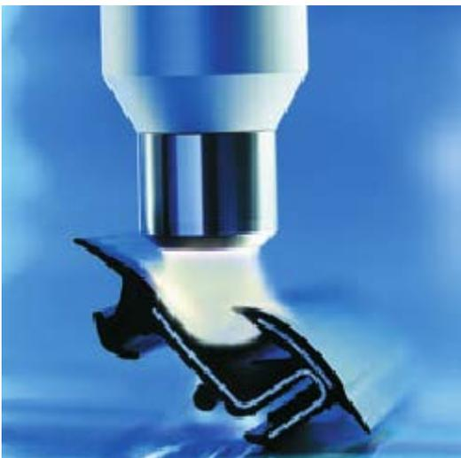
Abb. 6 Plasmabehandlung eines Kunststoffprofils (Foto: Plasmatrete)
