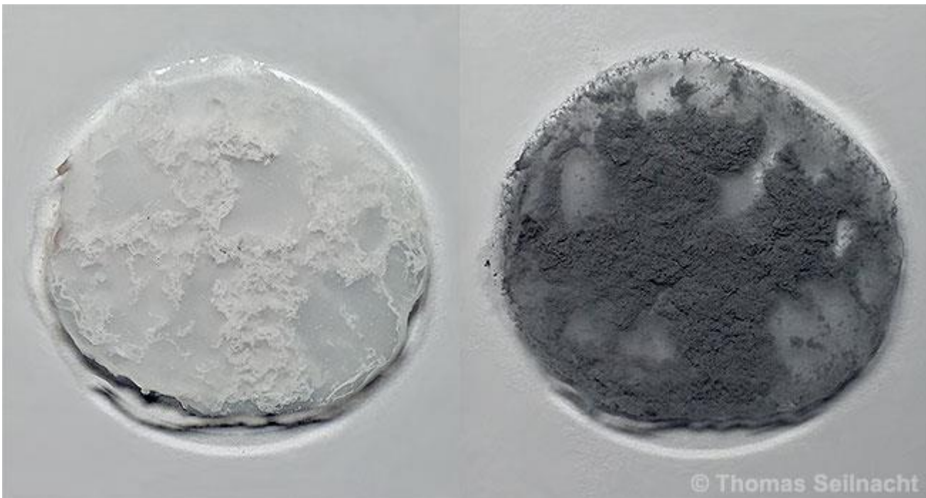
Abb. 3: Durch Fällung hergestelltes Silberchlorid färbt sich am Licht nach kurzer Zeit dunkel.
