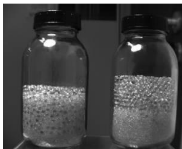
Abb. 2: Beispiel zum Paranuss-Effekt. Gemisch aus kleinen und grossen Gaskugeln vor (links) und nach dem Schütteln (rechts). Auf den Martini übertragen: Die grossen aromatischen Moleküle kommen oben und die kleinen Ethanol-Moleküle unten zu liegen. Quelle: S. Herminghaus: "Dynamics of wet granular matter". Advances in Physics 54 (2005) 221
