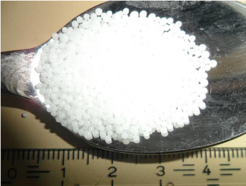
Abb. 3: Expandierbares Polystyrol vor dem Erhitzen (Durchmesser 0.3mm)
