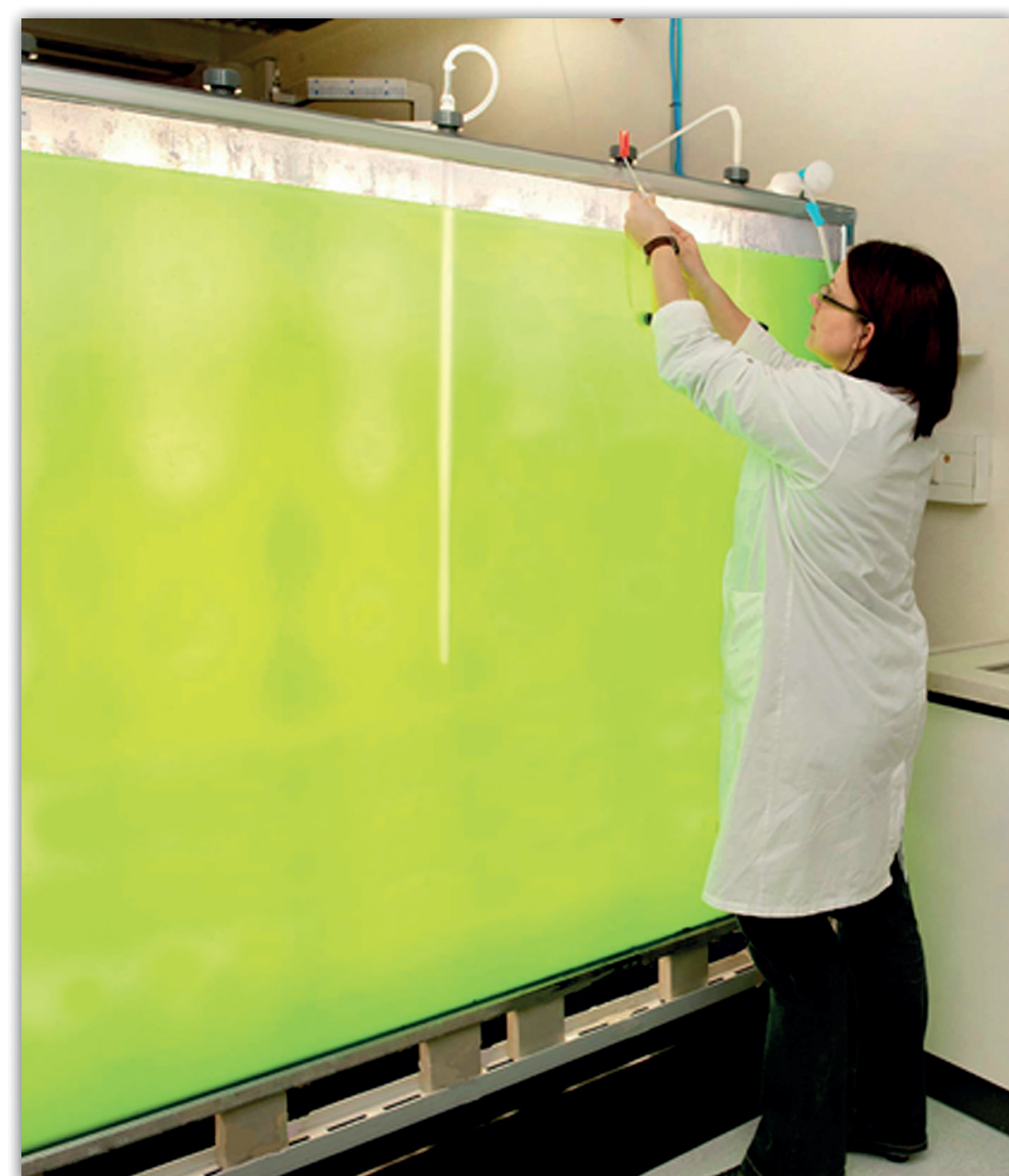
100 L Flachbett - Photobioreaktor (Pilotanlage in Kooperation mit Fa. KSD) zur Massenzucht von Cyanobakterien)
